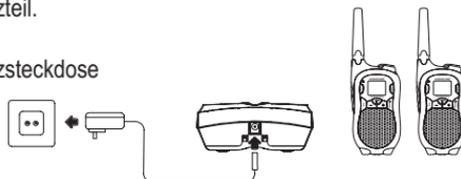
Stellen Sie die Funkgeräte vor der ersten Inbetriebnahme für mindestens 14 Stunden in die Ladestation. Wenn die Funkgeräte korrekt in der Ladestation stehen, leuchten die roten LEDs. Die roten LEDs leuchten auch, wenn die Akkupacks komplett aufgeladen sind.
