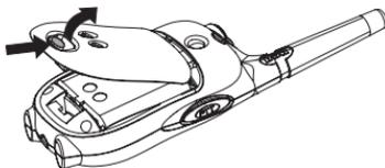
**⚠ Achtung:** Standard Akkus und Batterien werden in der Ladestation nicht geladen. Verwenden Sie nur den mitgelieferten Akkupack oder Akkupacks der gleichen Bauweise.
