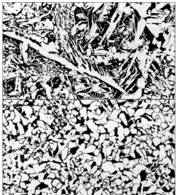
Stahlguss 0,25% C. Gusszustand (oben), normalgeglüht (unten)
