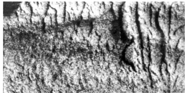
Glühzustand, zähes Bruchgefüge
