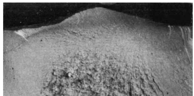
Gehärtet von 980°C – 15 Min - > Wasser, tiefere Einhärtung und Überhitzungserscheinung leicht glitzernd am Rand erkennbar
